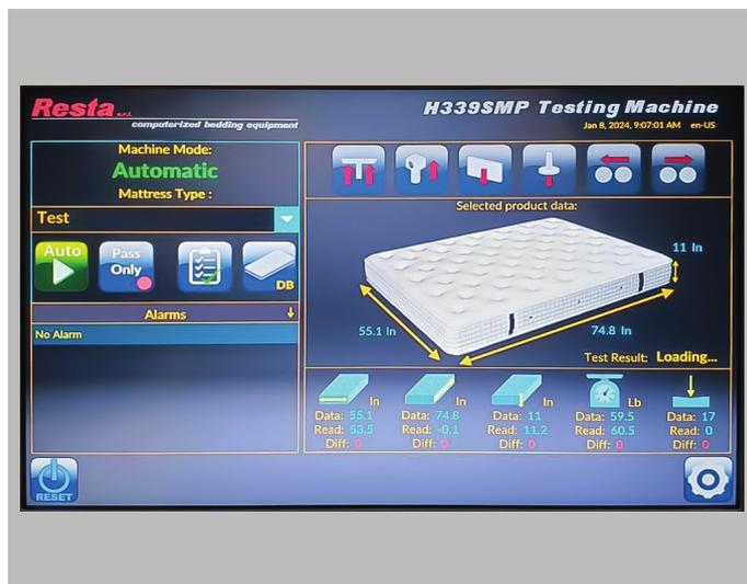
■ **Dimensionale Prüfstelle für Matratzen mit integriertem Transportförderer, sowohl unabhängig nutzbar also auch in eine Produktionslinie integrierbar.**
