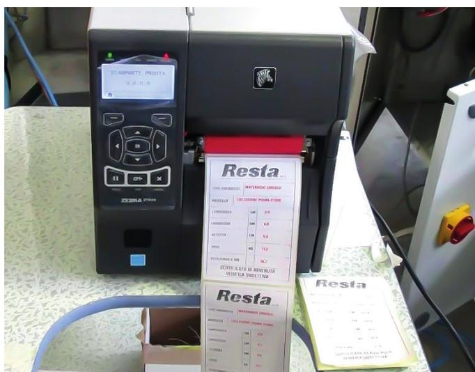
■ **Individuell anpassbarer Drucker: Ideal zur Erfassung der mit der H339 SMP ermittelten Daten auf vorgefertigte Felder, selbstklebende Etiketten oder Kartonetiketten.**
