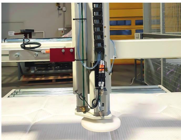
■ **Tastfühler zur vergleichenden Tragfähigkeitsprüfung (optional: automatische Mehrzonenmessung).**
